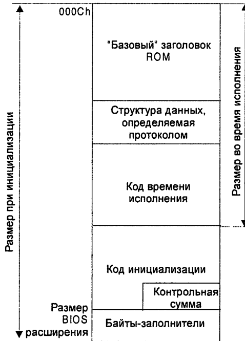
Рис. 8.1. Структура BIOS платы расширения PCI
