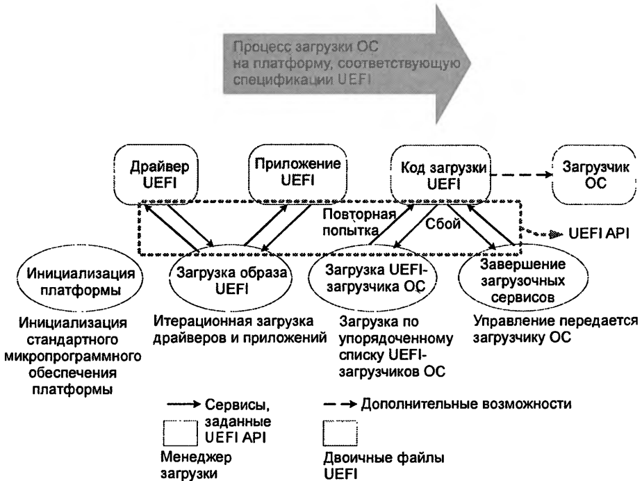
Рис. 15.3. Процесс загрузки, осуществляемый микропрограммным обеспечением, отвечающим требованиям спецификации UEFI
