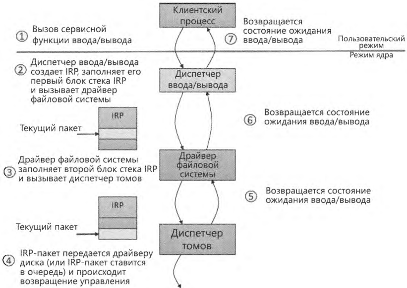
Рис. 6.18. Постановка в очередь асинхронного запроса к многоуровневым драйверам
