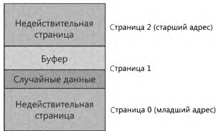
Рис. 6.31. Структура выделения буфера в специальном пуле
