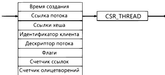
Рис. 4.4. Поля структуры CSR_THREAD
