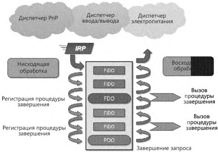
Рис. 6.13. Последовательность обработки IRP
