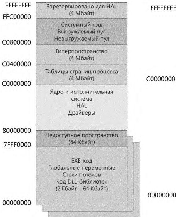
Рис. 5.12. Структура виртуальных адресных пространств ARM
