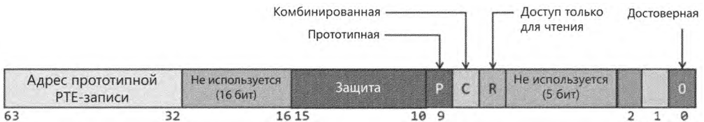
Рис. 5.25. Структура недостоверной PTE-записи, указывающей на прототипную PTE-запись
