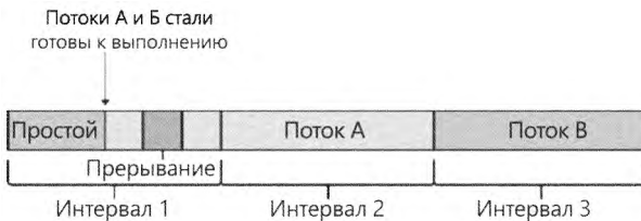
Рис. 4.18. Справедливое квантование времени в современных версиях Windows
