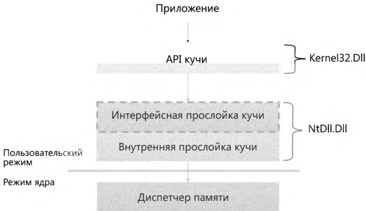
Рис. 5.8. Прослойки кучи NT в пользовательском режиме
