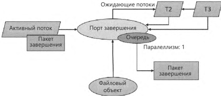
Рис. 6.25. Схема работы порта завершения ввода/вывода
