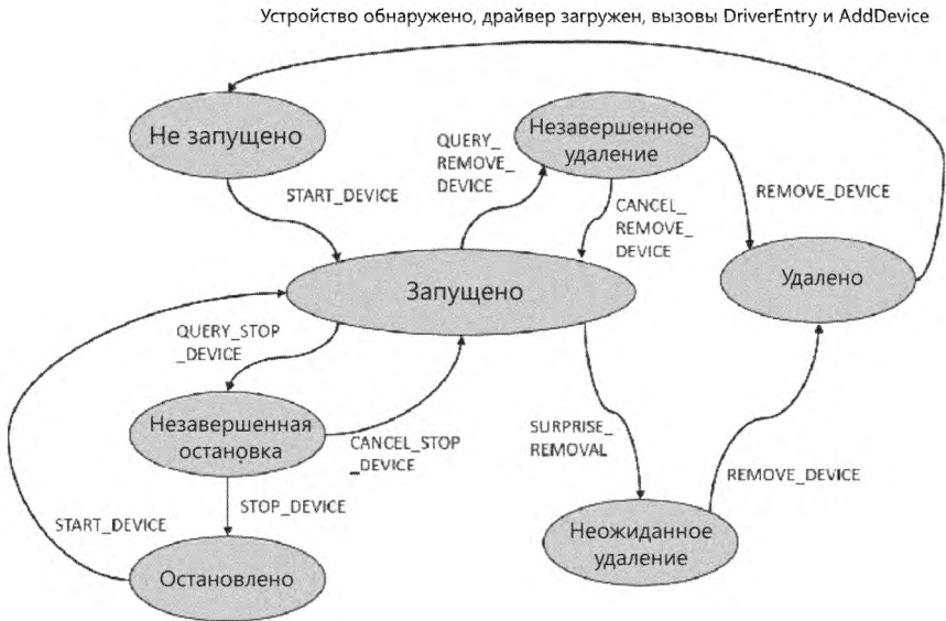
Рис. 6.41. Переходы между состояниями Plug and Play для устройств
