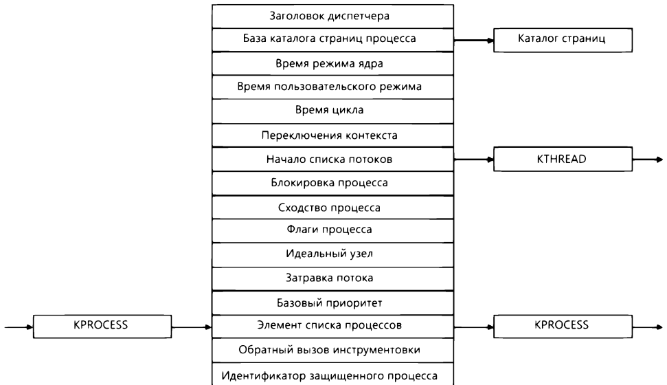
Рис. 3.3. Важнейшие поля структуры KPROCESS
