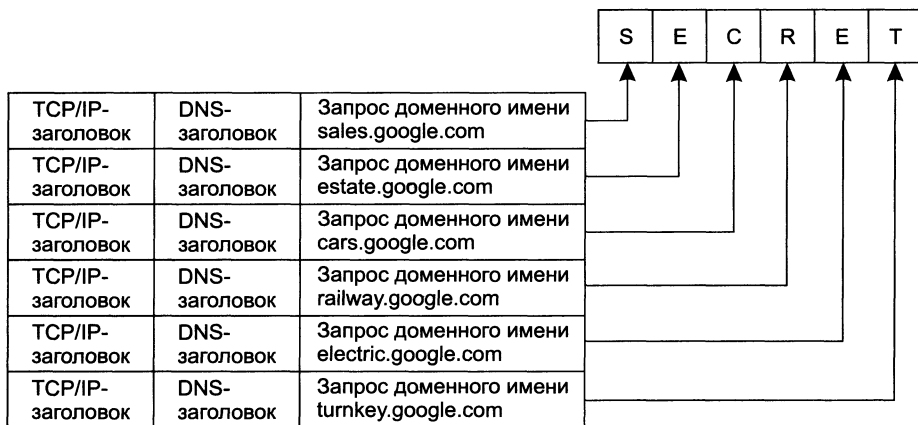
Рис. 9.1. Последовательность DNS-запросов, которая кодирует сообщение в форме акrostиха. Первая буква каждого доменного имени служит для передачи очередного символа сообщения «SECRET»
