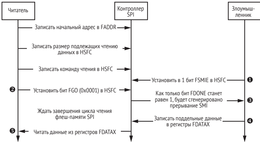
Рис. 19.6. Применение SPI для обмана программы чтения BIOS
