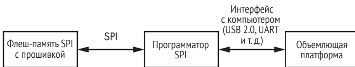
Рис. 19.7. Типичная схема выгрузки образа прошивки BIOS из флеш-памяти SPI
