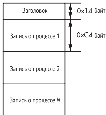
Рис. 12.8. Структура конфигурационного файла с информацией о внедрении полезных нагрузок
