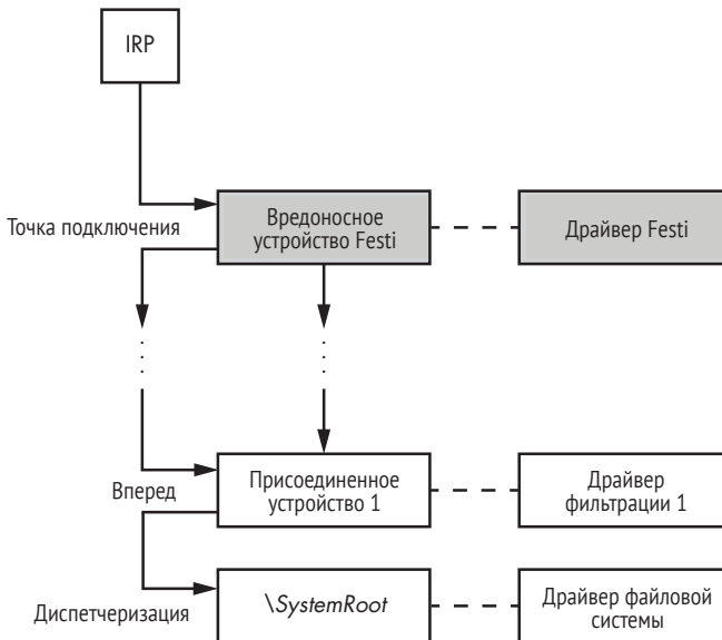
Рис. 2.8. Структура стека устройств файловой системы, к которому подключается Festi
