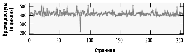
Рис. 8.6. Расход процессорного времени при доступе к массиву-зонду в 1 Мбайт
