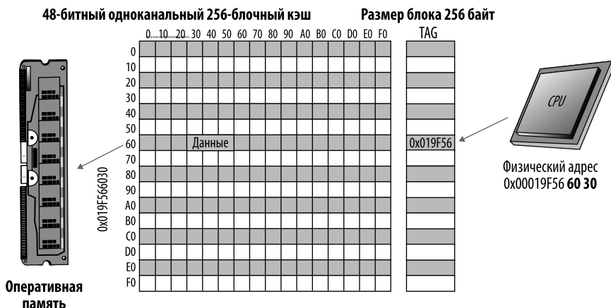
Рис. 8.4. Типовой 48-битный одноканальный кэш процессора
