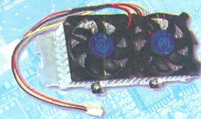
для одного из двух вентиляторов. Так что при остановке второго системный мониторинг предупреждение выдать не сможет. Зато в обоих вентиляторах
