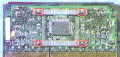
борке не вздумай его снимать! Стойки, держащие кожух, имеют на окончании конический срез и при обратном подсоединении (сборке) защелкиваются в кожухе практически намертво, как и было до разборки.
