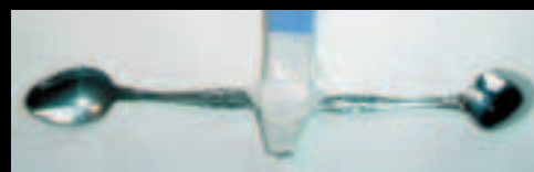
Искровые контакты нужно загнуть как можно ближе, чтобы между ними оставался небольшой зазор. Теперь искра будет проскакивать в несколько раз быстрее.
