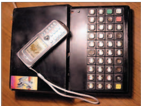
Самодельное устройство для сканирования и определения идентификационных характеристик сотовых радиотелефонов при их работе в сети оператора сотовой связи
