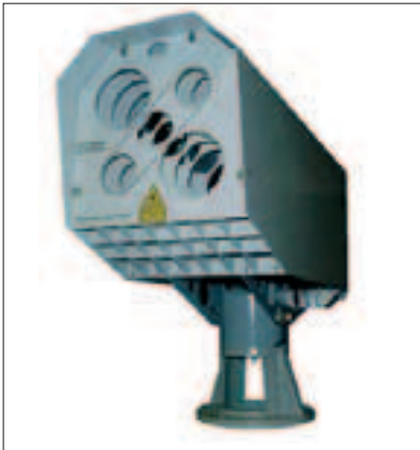
Детище Рязанского государственного завода, атмосферная оптическая линия связи МОСТ 100/500 - настоящая сказка для тех, кому нужна быстрая и стабильная связь на расстоянии более километра
