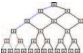
Потеря бит при переходе к четырехбитному кодированию
