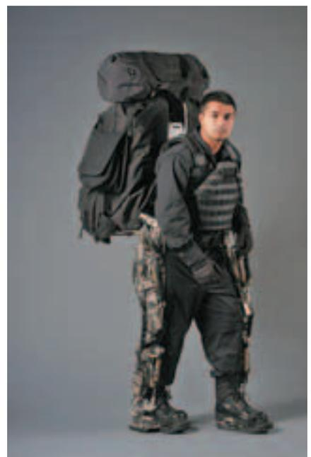
ботающей от ДВС, размещенного в специальном ранце. Все это позволяет владельцу скелета носить без каких-либо затруднений 90-100 кг груза. В настоящее время разработчики экзоскелета пытаются создать более удобный привод для своего детища, так как таскать с собой двигатель с запасом топлива в боевых условиях не слишком безопасно :). Еще один путь — биомеханические протезы, которые будут управляться биотоками мышц солдата. Но и это не снимает проблему получения энергии для него.
