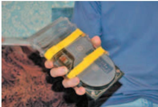
Винт помещается в пластиковую коробку, на которую наматывается проволока. Его легко заменить
