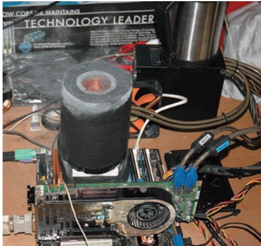
> Разгонный стенд испаряет десятый литр азота
