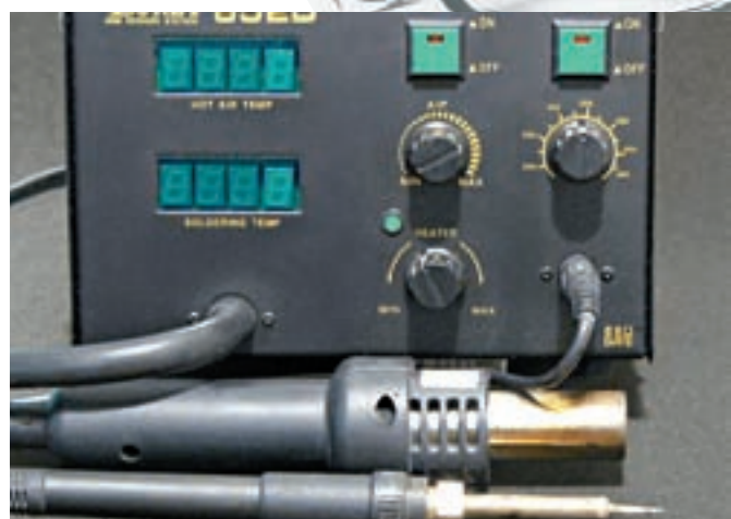
Одна из самых популярных термовоздушных паяльных станций — Lukey 852D+
