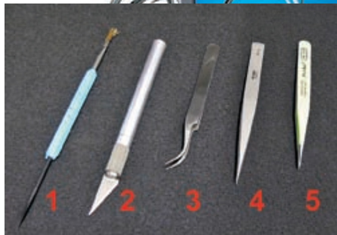
Набор инструмента продвинутого ковыряльщика железок. По порядку: 1 — зонд, совмещенный с металлической щеточкой, 2 — скальпель, 3 — угловой SMD-пинцет, 4 — прямой SMD-пинцет, 5 — SMD-пинцет с термоизоляцией
