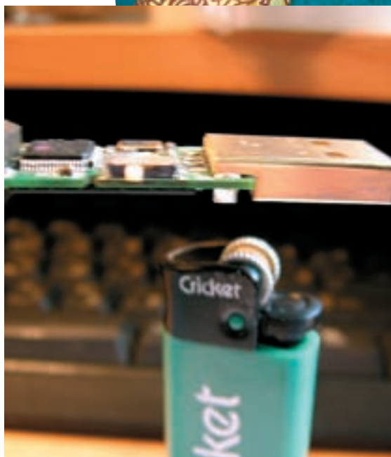
Отпаиваем зажигалкой USB-разъем
