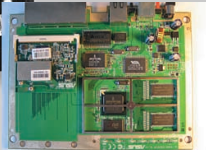
Мой домашний роутер от ASUS. На чипе от Broadcom с сердцем arm
