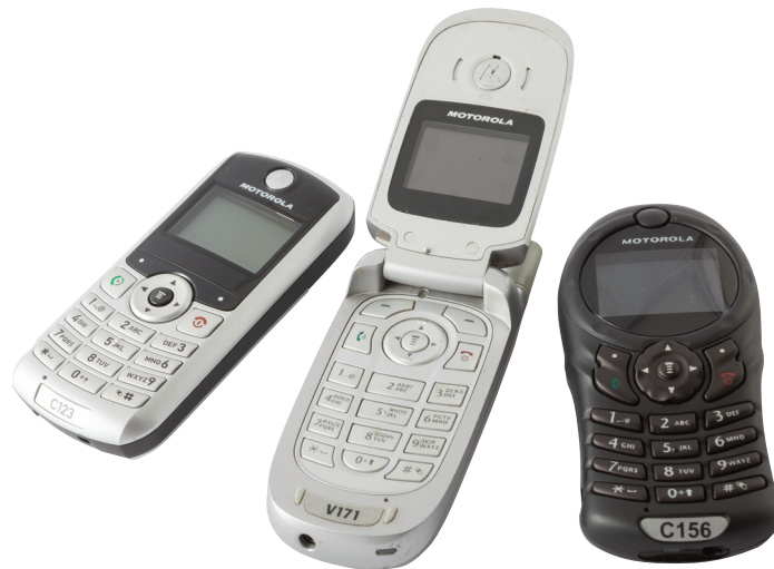
Старые мобильники Motorola на чипсете Calypso, на базе которых можно заниматься сниффингом GSM-трафика
