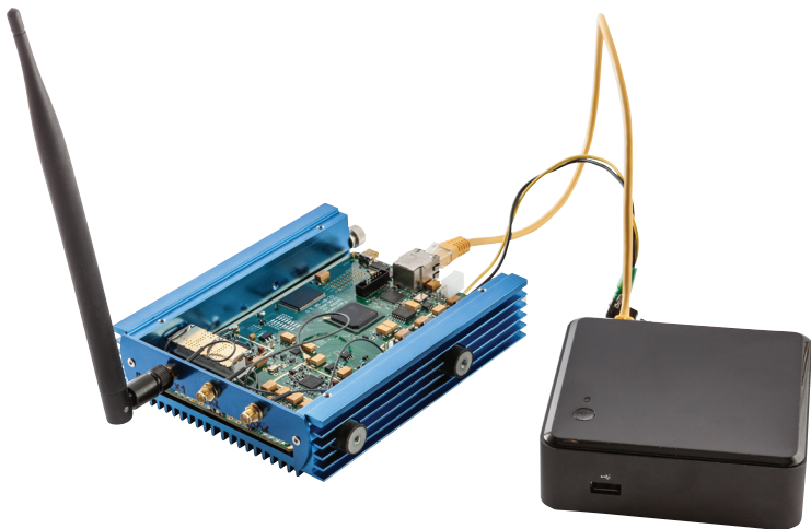
Трансивер UmTRX в связке с мини-компьютером Intel NUC
