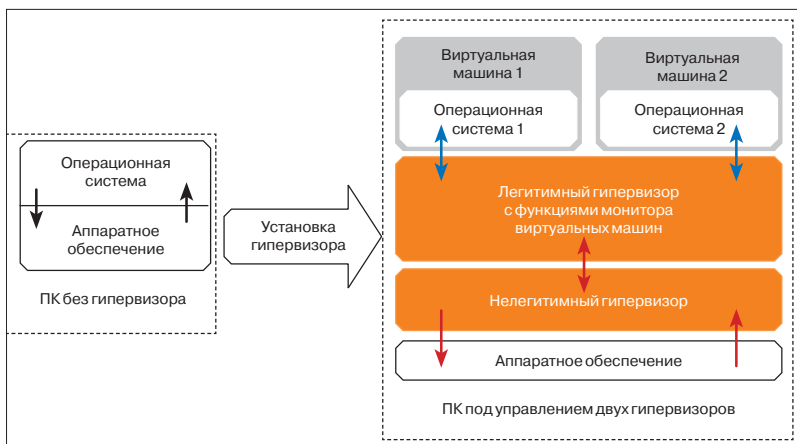
Рис. 2. Схема взаимодействия операционной системы с аппаратным обеспечением при отсутствии (присутствии) двух гипервизоров: легитимного с функциями монитора виртуальных машин и нелегитимного, находящегося во вложенном виде
