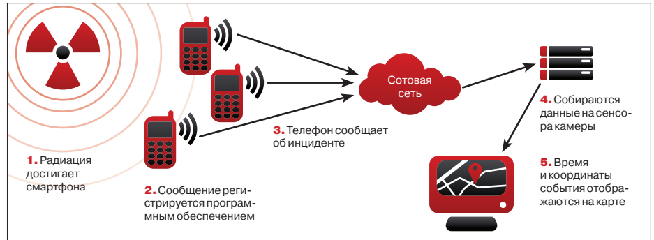
Рис. 1. Схема работы системы CellRAD
