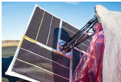
Рис. 4. Блок с фотоэлементами для питания электроники, которая прикреплена с обратной стороны
