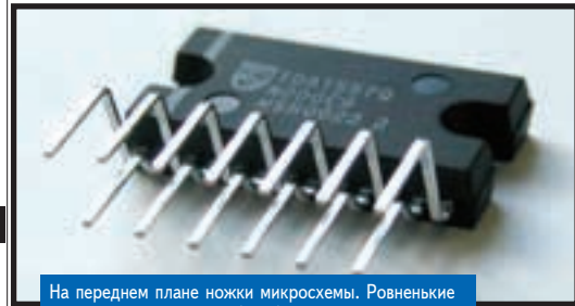
На переднем плане ножки микросхемы. Ровненькие на загляденье. Пушкни бы обзавидовался. 13 штук в два ряда. Первая - слева. А пазы по бокам для крепления к радиатору.
