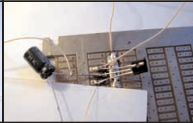
Маленький с тремя ножками - это транзистор. А толстенький - это конденсатор. Сверху приходят проводки с резистора, минус и плюс с батареи. Плюс припаян к толстенькой дорожке. А снизу выходят два проводка на трансформатор.
