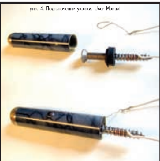
рис. 5. Шуруп, вставленный в водопроводную прокладку
