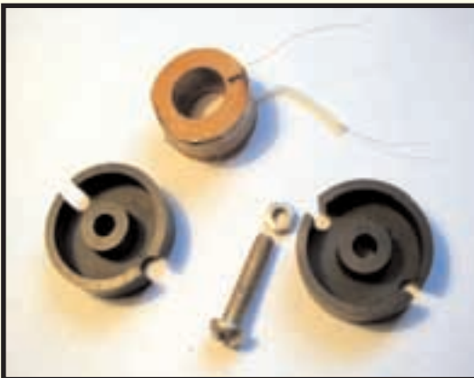
Ты видишь ферритовые чашки, между ними винт и гайка, выше - катушка. Похоже устроен и наш трансформатор, только у него обмоток больше.
