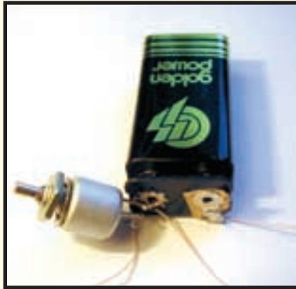
Батарейка типа "крона" и подстроечный (т.е. регулируемый отверткой) резистор. Резистор включен между базой транзистора и плюсом питания. Этой ручкой можно подстраивать частоту проскакивания искры.
