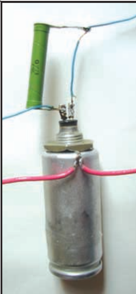
Еще один фильтр, через который подключено питание усилка по синему проводу. Фильтры нужны для того, чтобы очистить питание от помех.
