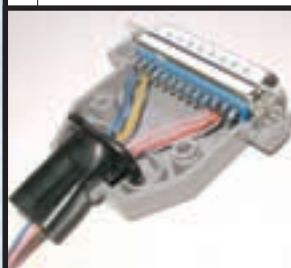
Тоже внешний соединитель, но всего с 4 проводками. Три ты уже знаешь: четвертый (синий) - это земля. Здесь мы уже купили новый разъем на ЛПТ.
