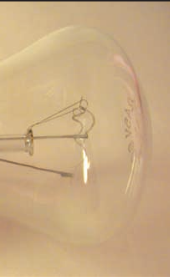
Отпаиваем центральную пупочку и сверлим сбоку дырочку
