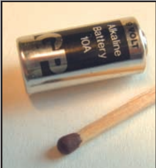
Питается наш жук от такой миниатюрной батарейки. Хотя можно и от 6-вольтовой, и от 3-вольтовой.
