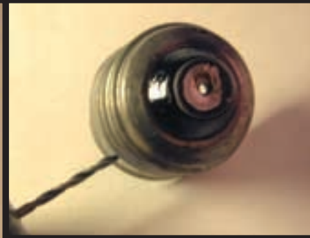
Отпаиваем центральную пупочку и сверлим сбоку дырочку
