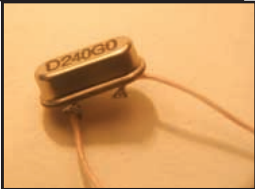
Это наш кварцевый резонатор на 24 мегагерца. Такой корпус называется "Лодочка". Кварц размером с три спичечных головки. Он нужен для того, чтобы задать несущую частоту.
