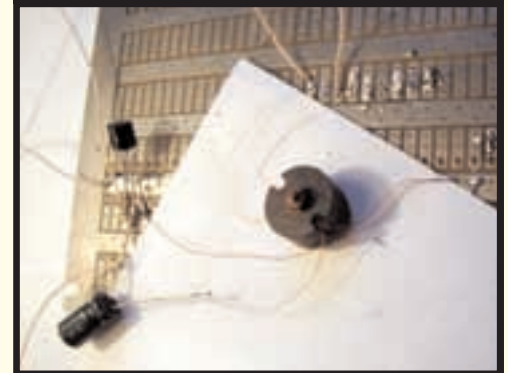
Чтобы ты лучше разглядел, мы подложили листочек. Теперь видно, что два проводка трансформатора соединены с генератором на транзисторе. Еще два мы припаяли к дорожке с плюсом от батареи. И еще два - выход на умножитель.
