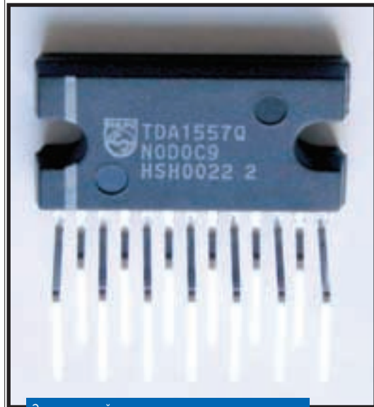
Этот маленький чип размером с ноготь на самом деле - крутой аудиусилитель. Остается только правильно к нему подключить питание, аудиовходы и выходы.
