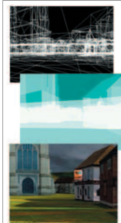
Этапы представления 3D при визуализации (эскизная модель, область видимого (альфа-канал) и итоговая картинка)
