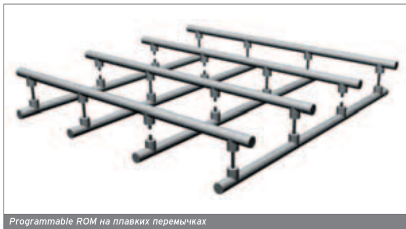
Programmable ROM на плавких перемычках
