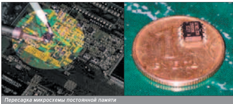
Пересадка микросхемы постоянной памяти
