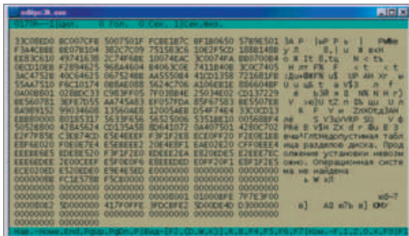
Рис. 5. Сектор MBR в шестнадцатерично-символьном виде
