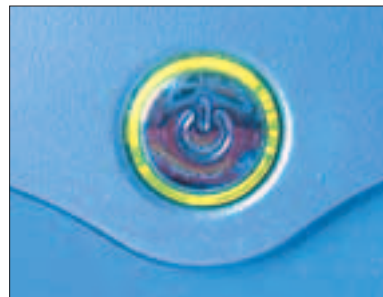
Кнопка питания моника, по которой легко определить наличие напряжения
