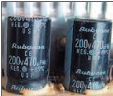
Если эти электролитические конденсаторы "высохнут", качество питающего напряжения значительно ухудшится
