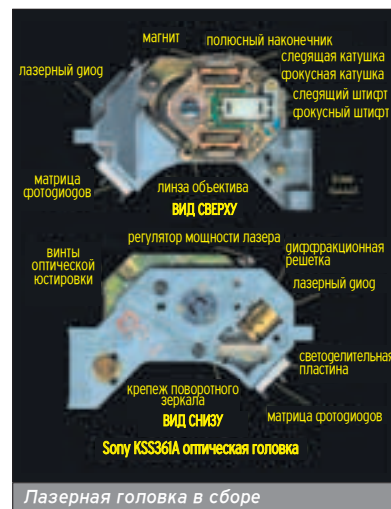
Лазерная головка в сборе
