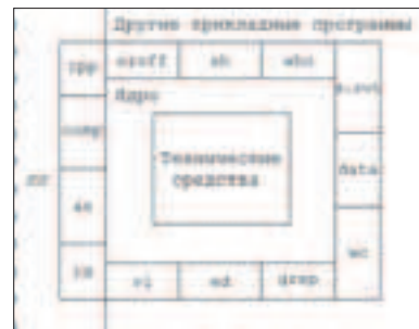
Архитектура UNIX в очень упрощенном виде
