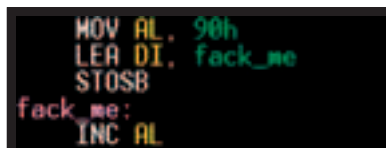
Рис. 5. Модификация машинной команды, уже находящейся на конвейере
