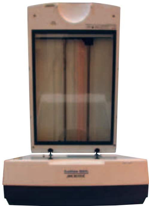
Сканер для ежедневного рутинного использования. Рабочая лошадка со слайд-модулем для черного сканирования слайдов (окончательное сканирование производится на барабанных сканерах профессионального класса)
