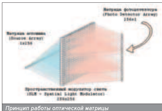
Принцип работы оптической матрицы
