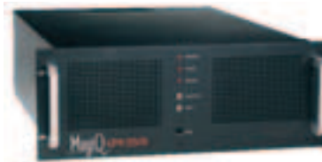
Вот так прозаично выглядит коммерческая система квантовой криптографии MagiQ QPN5505.
