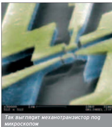
Так выглядит механотранзистор под микроскопом
