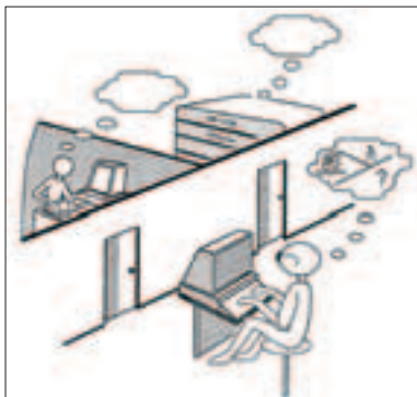
Тест Тьюринга: человек-наблюдатель должен отличить компьютерную систему, которую требуется протестировать, от собеседника-человека
