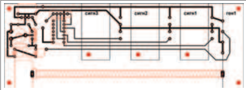
Рис. 06. Кросс-плата. Разводка проводников
