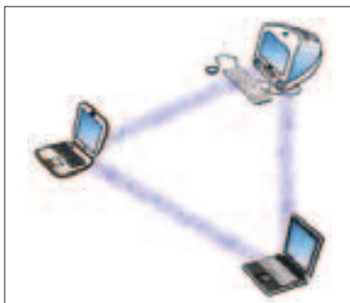
Схема подключения Ad-hoc: устройства подключаются друг к другу напрямую
