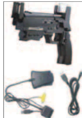
С виду пистолет, а на самом деле - направленная антенна, отстреливающая беспроводные устройства с приличного расстояния
