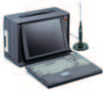
Компьютер + сканер диапазона 900 МГц - так выглядит большинство систем мониторинга связи
