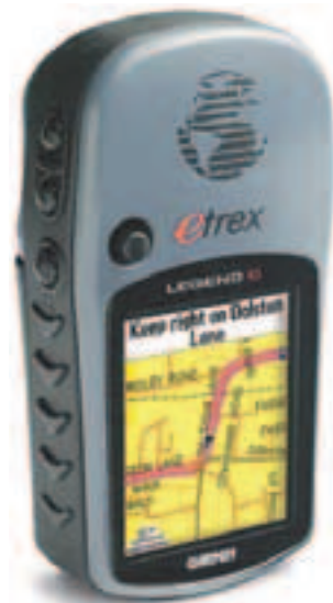
Навигатор Garmin E-Trex Legend C имеет большой цветной дисплей и подключается по USB
